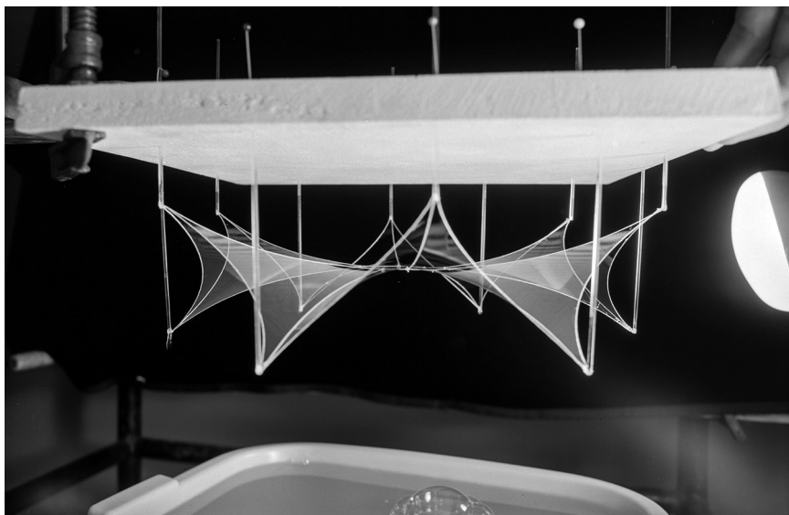
Ill. 8 : Maquette de bulles de savon du Tanzbrunnen (pavillon de danse), Entwicklungsstätte für den Leichtbau EL (Centre de développement pour la construction légère), Berlin 1957. © saai / Archive for Architecture and Civil Engineering, Karlsruhe Institute for Technology.
