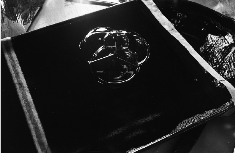
Ill. 5 : Trois bulles de savon de taille égale assemblées pour créer une forme régulière, Atelier Warmbronn. © saai / Archive for Architecture and Civil Engineering, Karlsruhe Institute for Technology.
