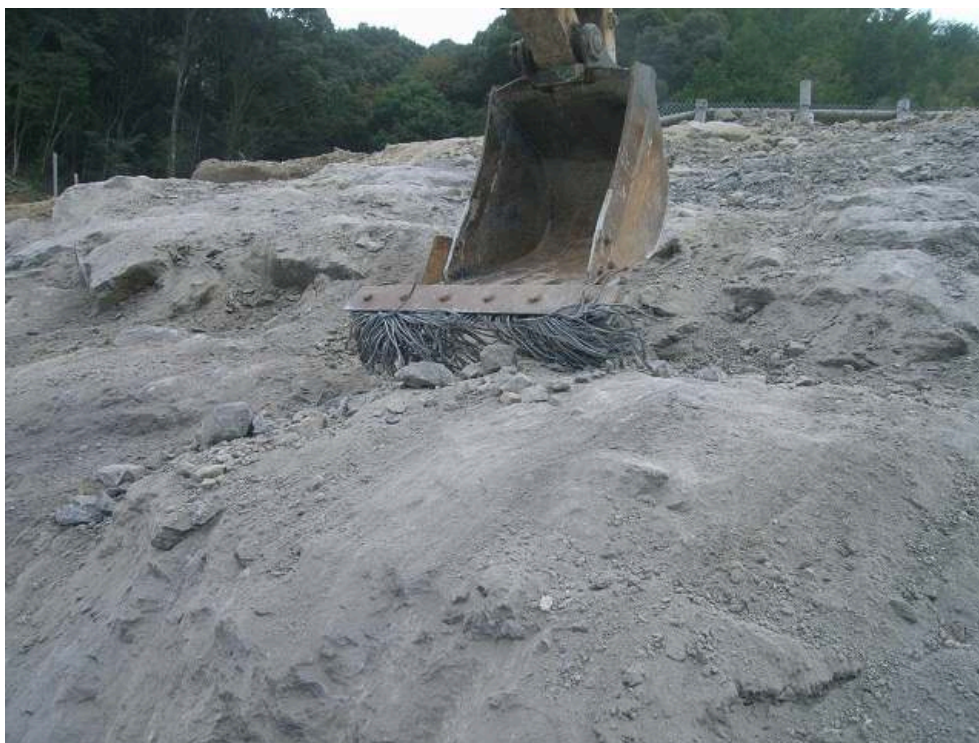
図11 ワイヤブラシを固定したバケット
