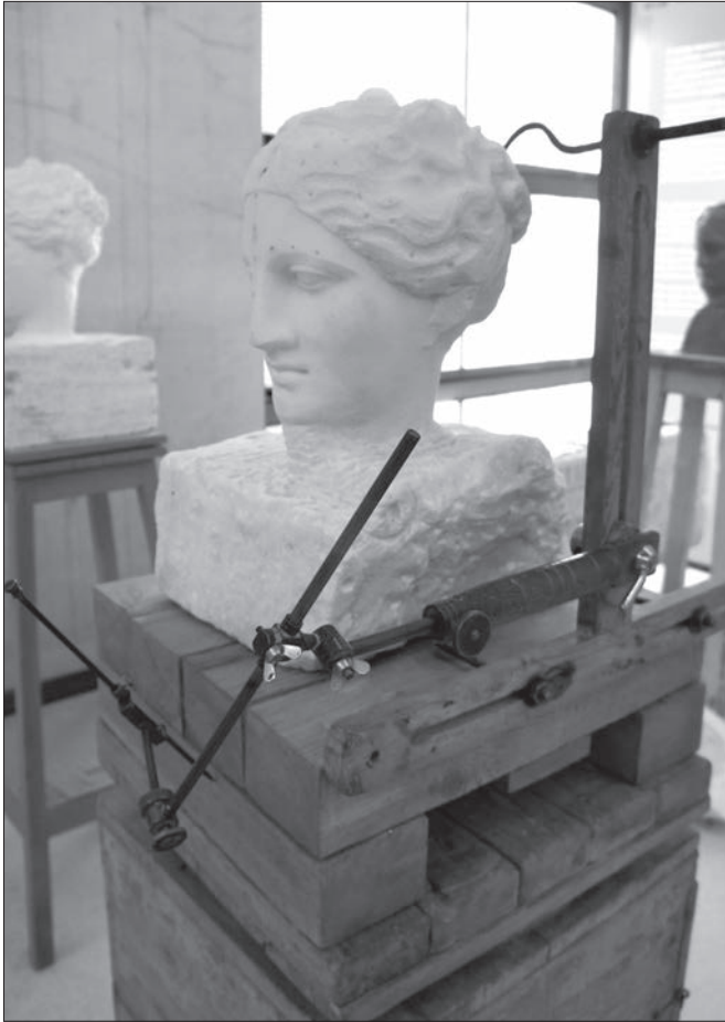
Fig. 5. Machine à pointer. Musée des artisans de la pierre. Village de Pyrgos, île de Tinos, Cyclades (Cliché S. Moureaud).
