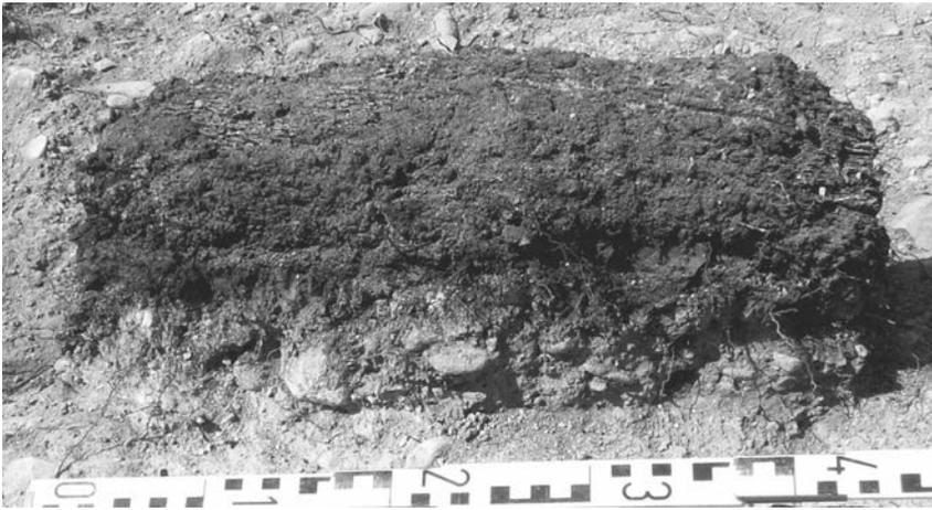
Fig. 78. Échantillon dendrochronologique prêt à être plâtré et prélevé. Poutre de la sablière basse du mur ouest (prélèvement DENDALM 39) (Cliché Daniel Mouton).
