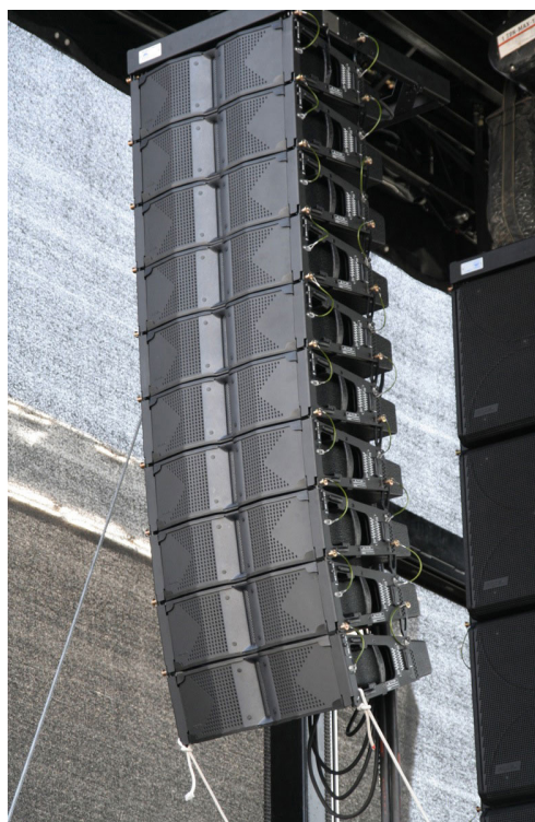
Fig. 3. Exemple d'un système Line Array / Example of a Line Array system Source : Wikipedia , par Rudolf Schuba .
