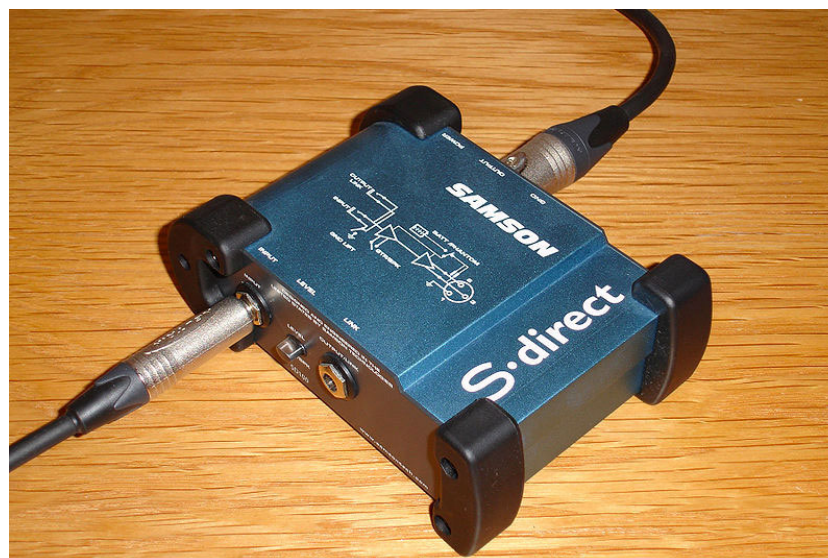
Fig. 1. Boîtier d'injection directe / Fig. 1. DI box © Bene Source : Wikimedia Commons .
