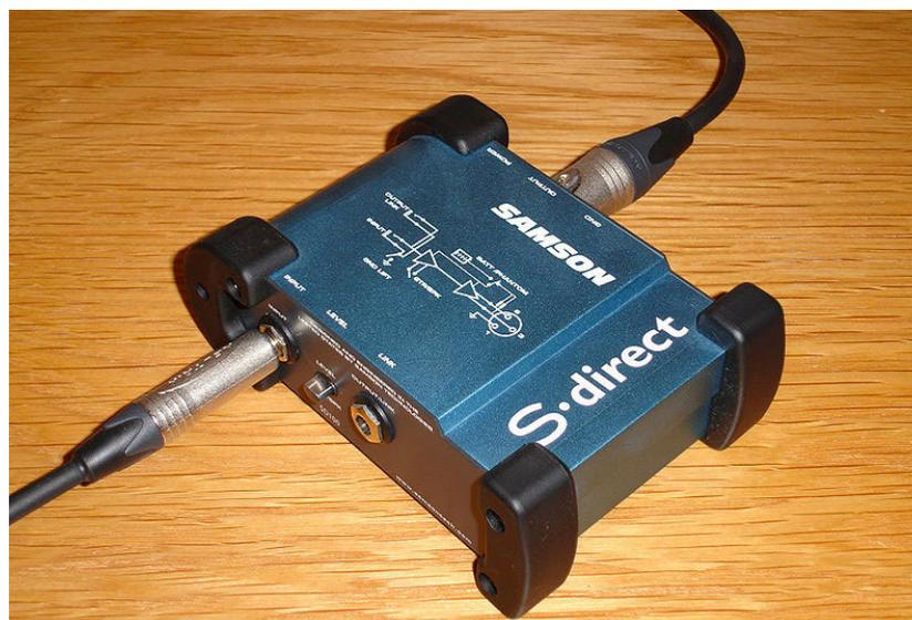
Fig. 1. Boîtier d'injection directe / Fig. 1. DI box
