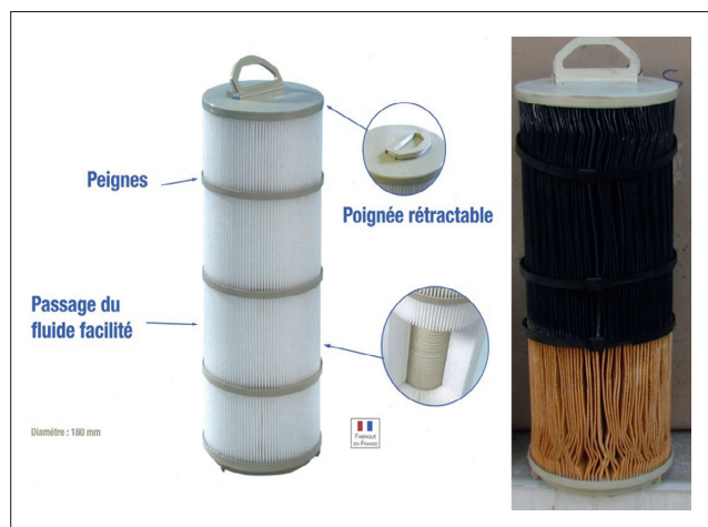
Fig. 3. Le matériel utilisé pour la filtration des bains, filtres à particules d'une maille de 2\ \mu\text{m} ; à droite, un filtre utilisé après lavage à l'eau en partie basse. © ARC-Nucléart.
