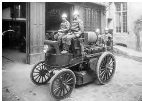
Fig. 5 et 6. Le fourgon d'incendie électrique, de face et d'arrière. Une vraie modernité se dégage de ce véhicule avec sa compacité, son phare à l'avant et son esthétique fort éloignée de celle des voitures hippomobiles ( http://www.culture.gouv.fr/public/mistral/memsmn_fr ).
