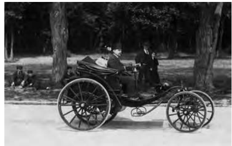
Fig. 4. La voiture du brevet Krebs au bois de Boulogne. Antoine, le jeune fils, prend en photo son père et sa mère à bord de la voiture construite chez les pompiers ; on aperçoit sous le guidon le commutateur de la boîte de vitesse électromagnétique (archives Krebs).
