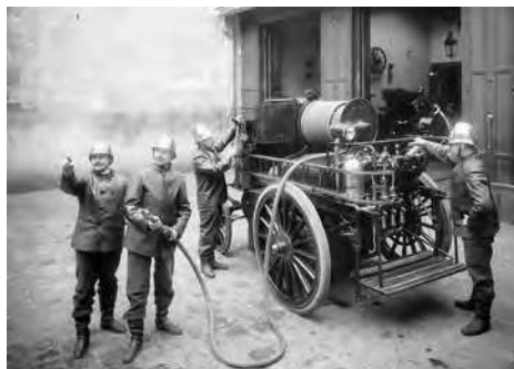
Fig. 5 et 6. Le fourgon d'incendie électrique, de face et d'arrière. Une vraie modernité se dégage de ce véhicule avec sa compacité, son phare à l'avant et son esthétique fort éloignée de celle des voitures hippomobiles ( http://www.culture.gouv.fr/public/mistral/memsmn_fr ).
