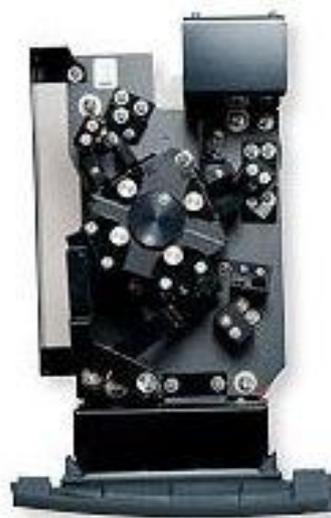
Figura 22 - Esfera integradora para o espectrofotómetro Shimadzu UV-2600 [22]
