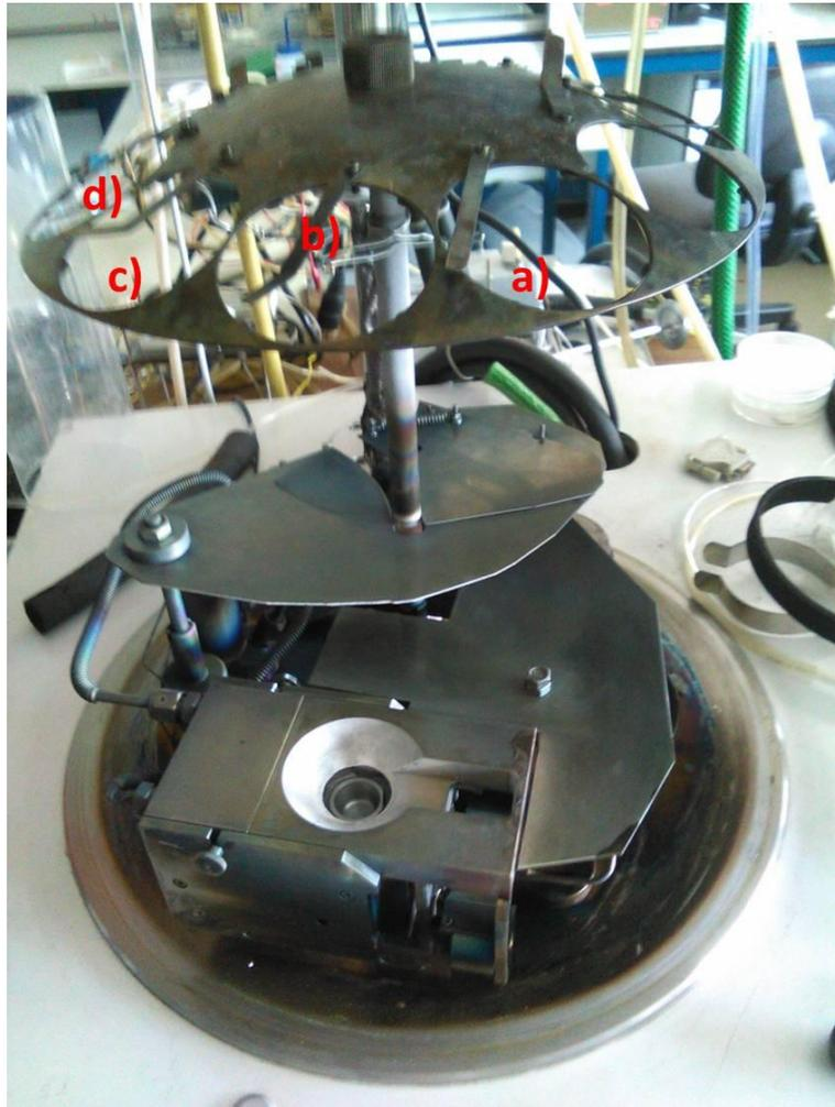
Figura 35 - Posição das amostras durante a deposição dos filmes de  $\text{TiO}_2$
