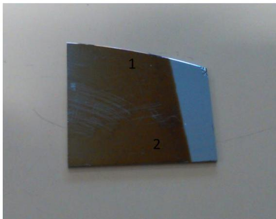
Figura 48 - Amostra 10 com filme de  $\text{TiO}_2$
