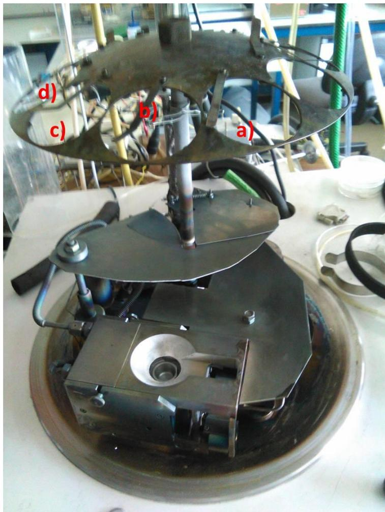
Figura 49 - Posição das amostras durante a deposição dos filmes de  $\text{TiO}_2$
