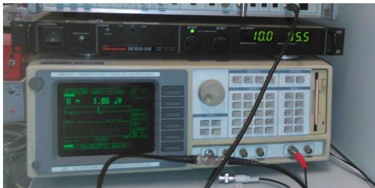
Figura 20 - Imagem da fonte de tensão DC e do amplificador do tipo “lock-in”
