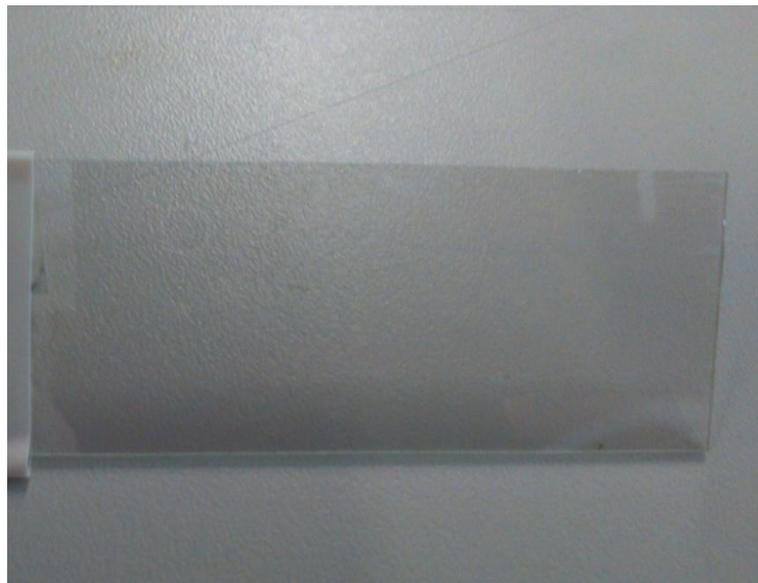
Figura 51- Lâmina de vidro com um filme de TiO<sub>2</sub> depositado
