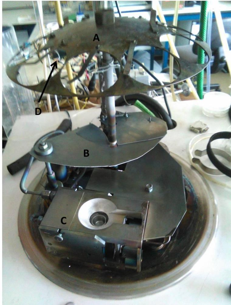
Figura 28 - Interior da câmara de evaporação (A- Suporte para as amostras; B - "Shutter"; C - Canhão de electrões; D - local onde se encontra o sensor de espessura)
