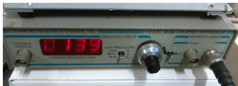
Figura 15 – Instrumento de controlo da velocidade de rotação do obturador
