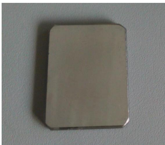
Figura 60 – 1º Espelho de alumínio usado como referência nas primeiras medidas da esfera integradora
