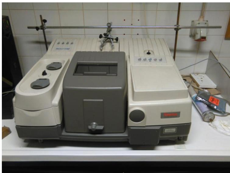
Figura 24 - Imagem do equipamento de FT-IR, modelo Nicolet 6700
