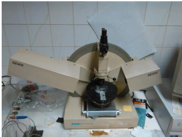
Figura 13 - Fotografia do elipsômetro, do modelo Sentech SE-400
