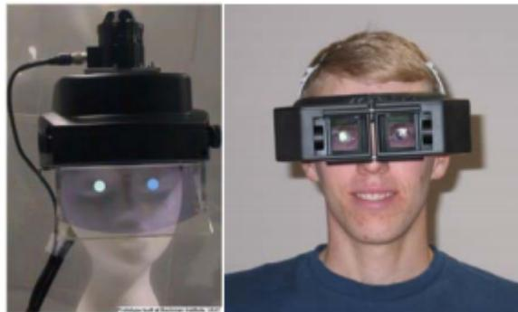
Figura 2.6: Exemplo de um protótipo de ecrã do tipo *Head-Mounted Projector* [16].
