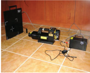
Şekil 17. X ışın tüpü Flat Panel ve ICU bağlantısı [14]
