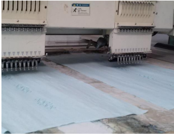
Imagen 1. Máquina para el bordado de las guayaberas
