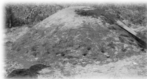
Imagen 11. Horno donde se elabora el carbón vegetal.
