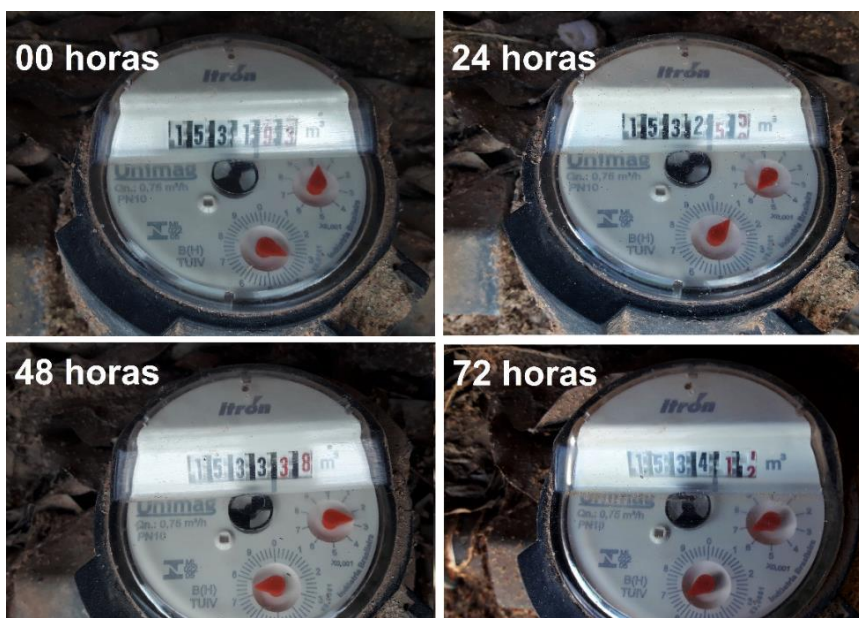
Figura 7. Fotos do hidrômetro do 2º ciclo de aferições com o registro totalmente aberto (Batista, 2019)
