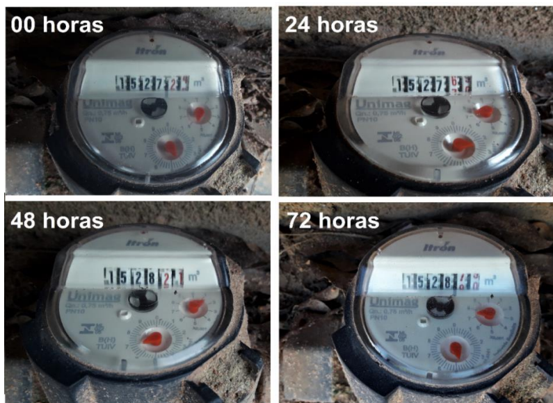
Figura 4. Fotos do hidrômetro do 1º ciclo de aferições com meia seção do registro (Batista, 2019)
