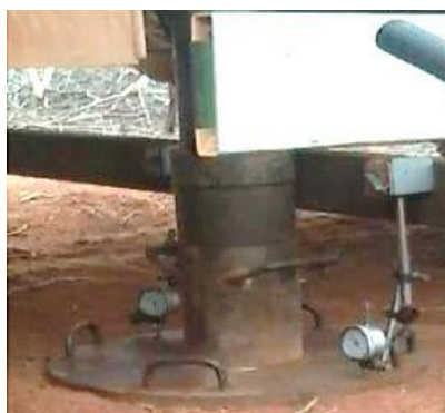
Figura 6. Detalhe da placa metálica utilizada nos ensaios (Rocha Brasil Engenharia Ltda, 2017)
