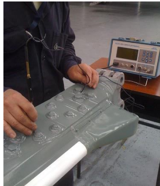
Figura 14. Inspección por corrientes Eddy
