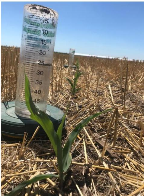
Foto 1: Determinación de Infiltración.
