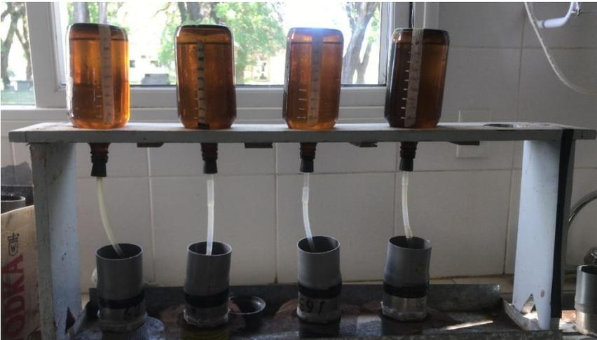
Foto 3: Determinación de conductividad hidráulica en laboratorio.
