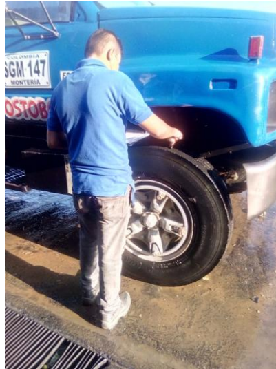
Imagen 26. Actividad de medición y monitoreo de estado de llantas
