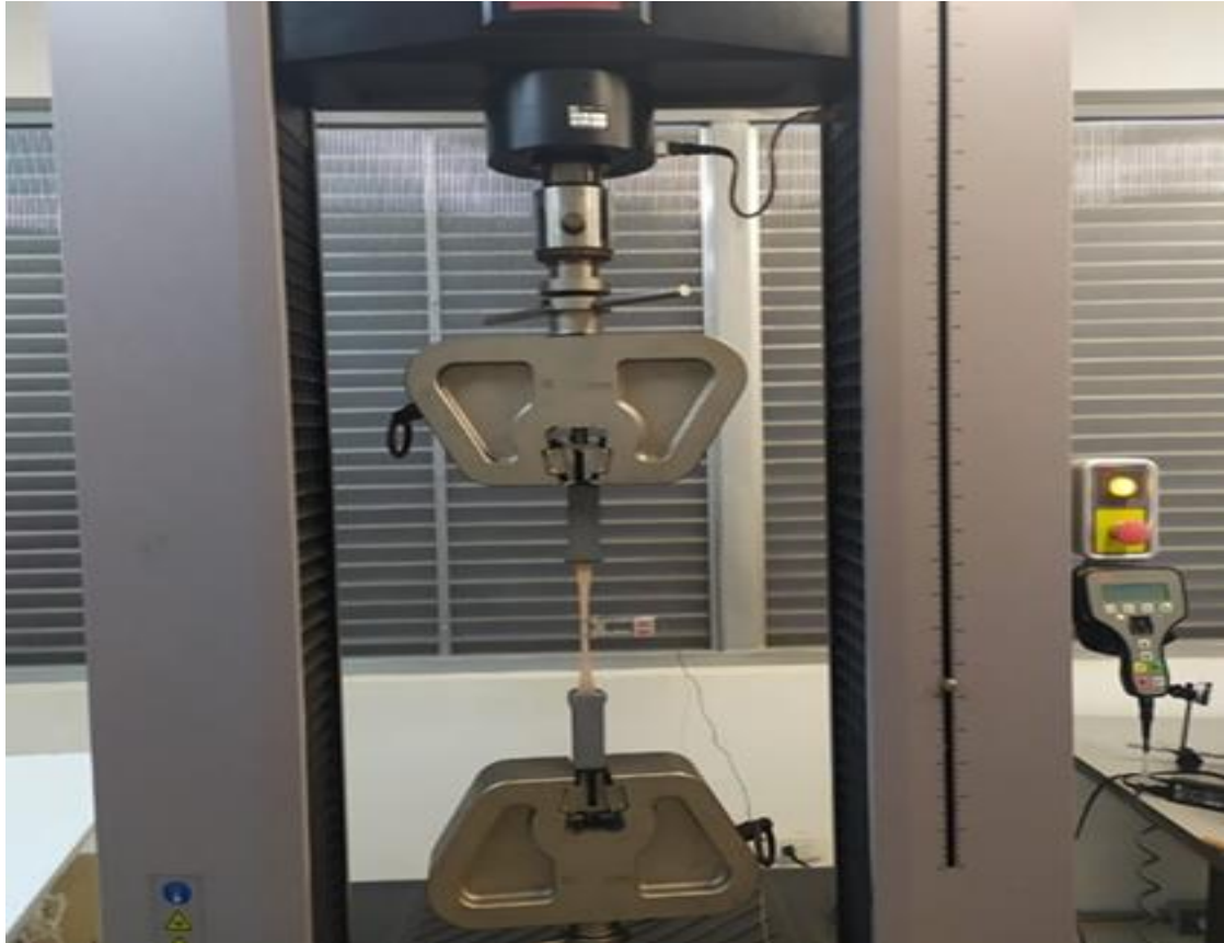
Figura 10. Montaje empleado para la realización de los ensayos de tensión en la máquina universal de ensayos MTS Criterion C45.305. ®
