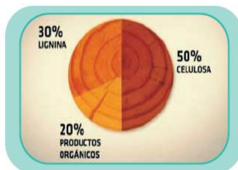
Figura 2. Composición de la madera.
