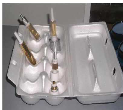
Рис. 2. Минирезонаторные кюветы с образцами.
