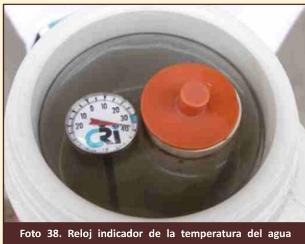
Foto 38. Reloj indicador de la temperatura del agua
