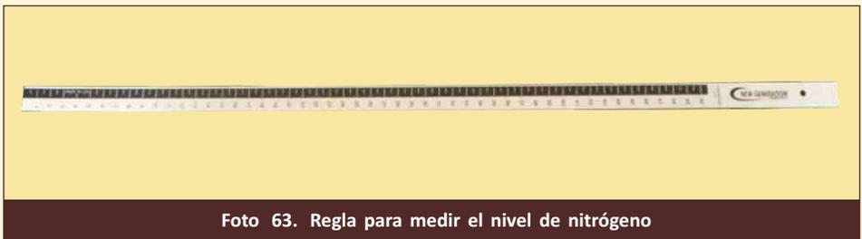
Foto 63. Regla para medir el nivel de nitrógeno
