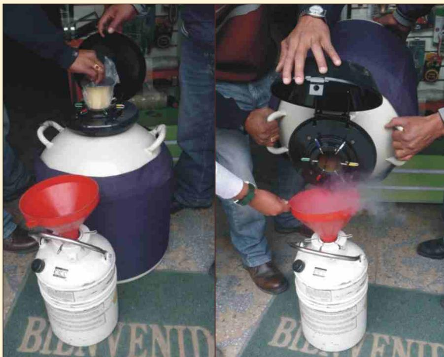
Foto 68. Vaciado de nitrógeno líquido
