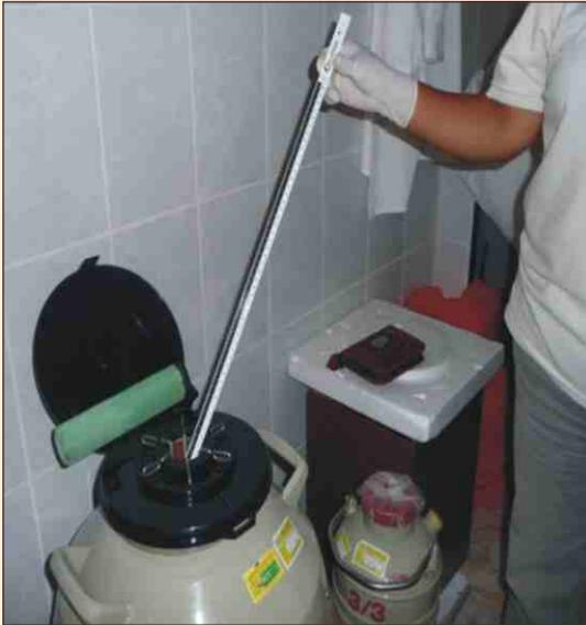
Foto 64. Forma de medir el nitrógeno
