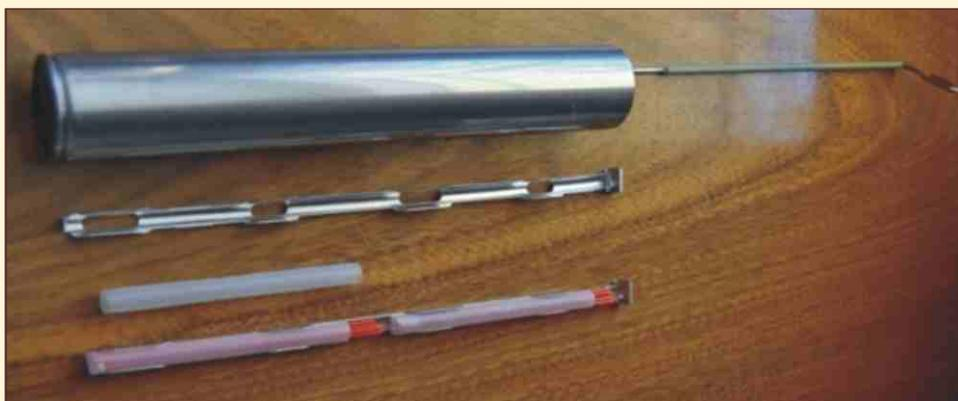
Foto 70. Canastilla, varilla, globet y varilla con globet y pajilla
