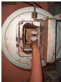
Calcinación de las muestras en la mufla.
