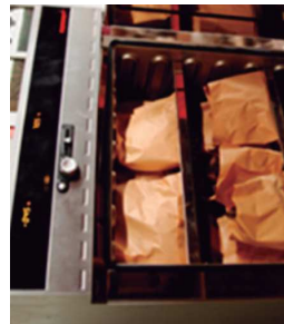
Secado de muestras a 40° C.
