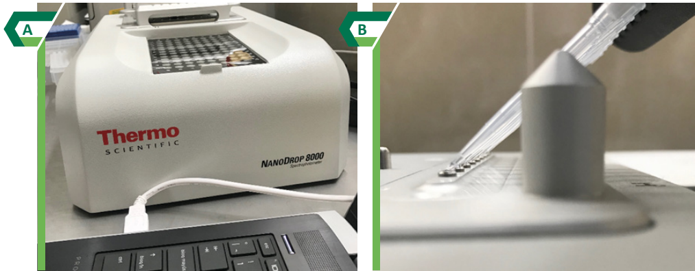
Figura 6. Cuantificación de ADN y ARN. Equipo de cuantificación NANODROP 8000 (A). Cargado de muestras en el NANODROP para cuantificación de ADN (8 muestras en simultáneo) (B).
