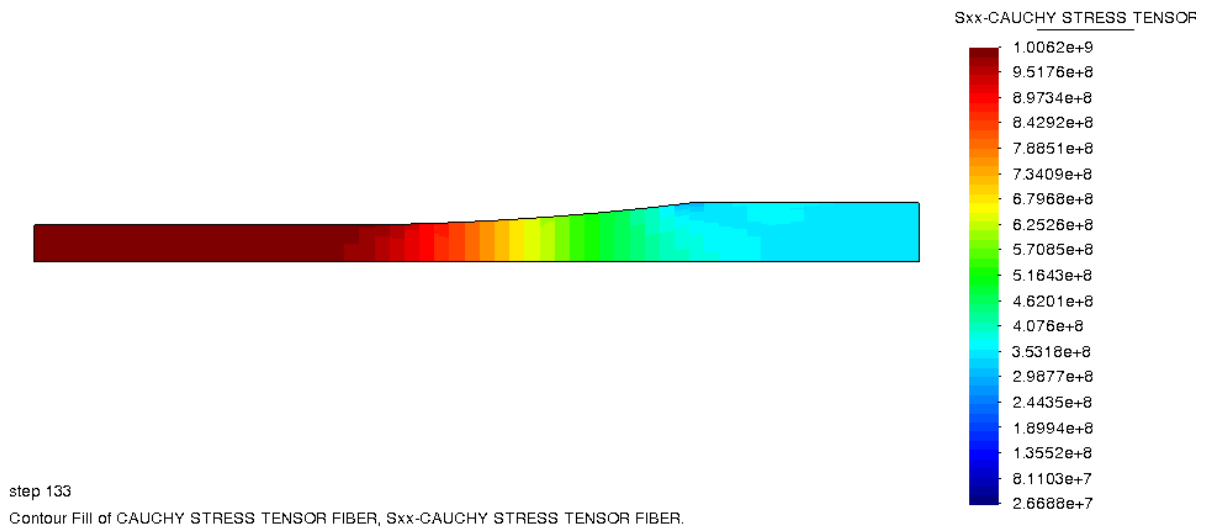
Figura 13.6 Tensión en la fibra [Pa]. Compuesto superior
