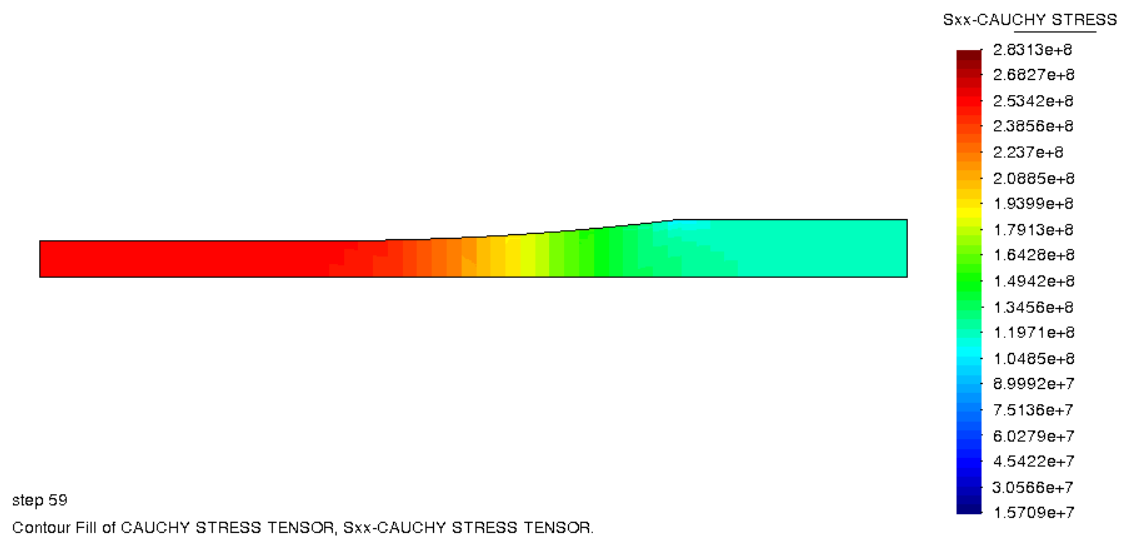
Figura 13.10 Tensiones en el compuesto [Pa]. Compuesto inferior
