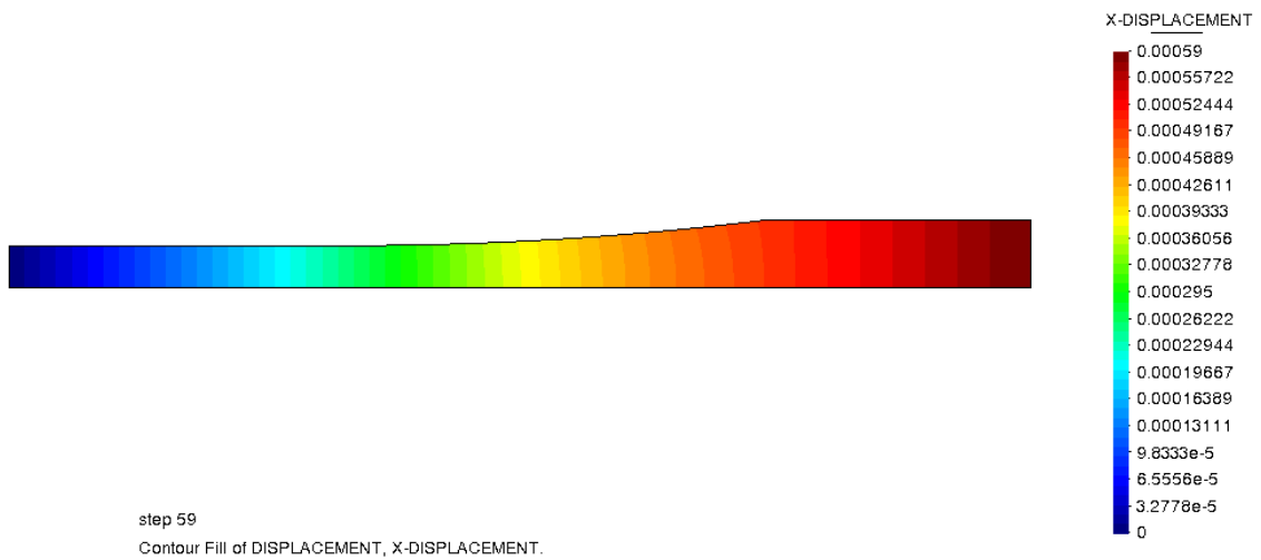
Figura 13.12 Desplazamientos[m]. Compuesto inferior
