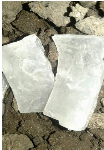
Figura 14: Muestra de almidón termoplástico de papa ( Solanum tuberosum ) rígido obtenido por el bajo contenido de glicerol sometido a medio de compostaje.
