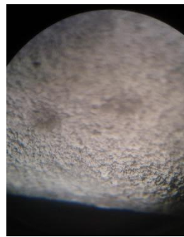
Figura 18 Estructura recristalizada de las biopelículas de almidones vista por el estereoscopio.
