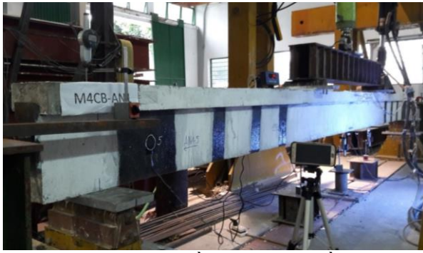
Hình 3. Sơ đồ thí nghiệm dầm
