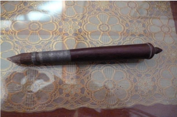
Hình 1. Dụng cụ dùng để khắc chữ trên kính lá buông
