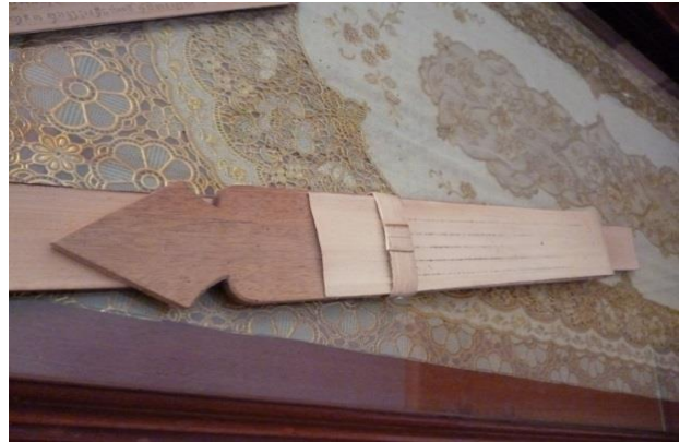
Hình 2. Giá đỡ dùng để cố định lá để khắc chữ trên kính lá buông
