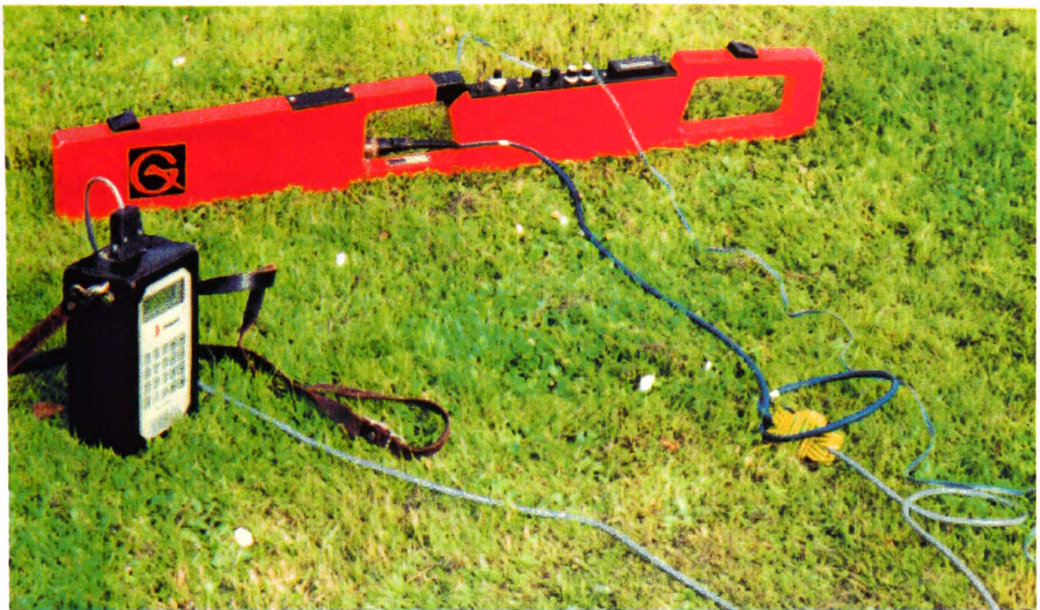
Fig. B.6 - EM 38 Geonics conductivity meter and data logger.
