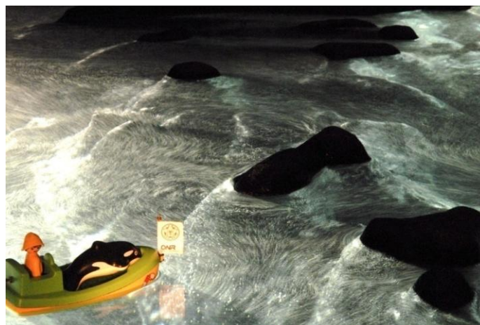
Figure 2.24 : Expérience du détroit de Luçon menée à la plateforme Coriolis par Mercier et al. (2013). (Photo de H. Didelle, T. Peacock & M. Mercier 3 )
