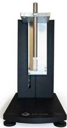
FIGURE 22 – Appareil de dip-coating utilisé pour mettre en forme les films
