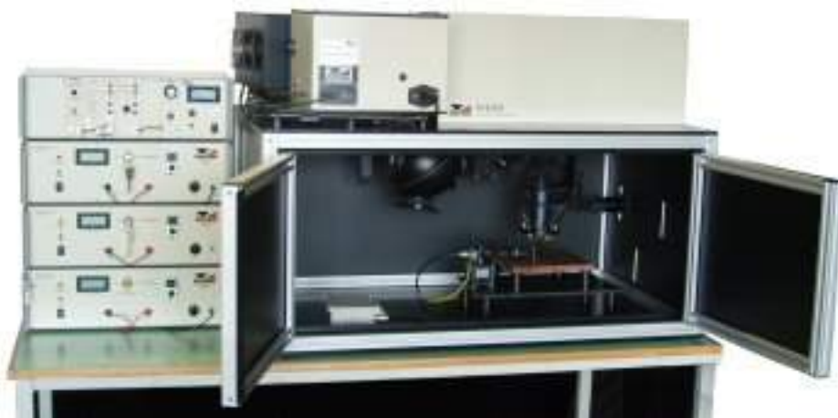
FIGURE 26 – Banc de caractérisation Bentham PV-300
