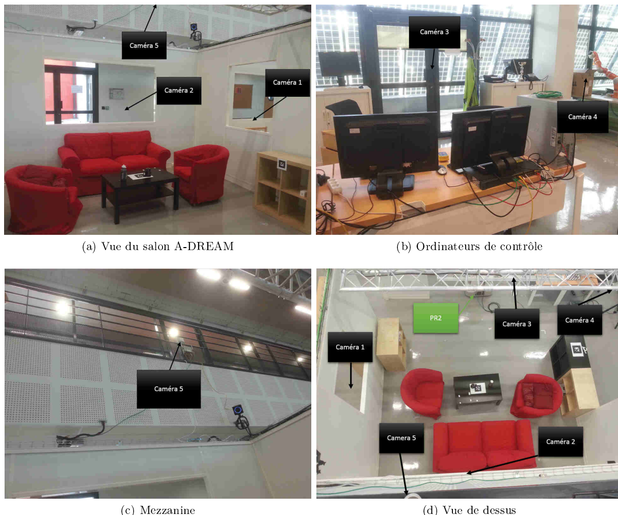
FIGURE 4.9 – Disposition des caméras dans l'appartement A-DREAM lors de la deuxième campagne d'acquisition.
