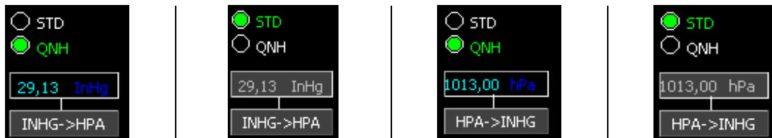
a) Mode QNH et unité InHg | b) Mode STD et unité InHg | c) Mode QNH et unité hPa | d) Mode STD et unité hPa
