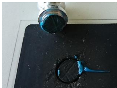
Abb. 1: Grenzschichtnahes kohäsives Versagen an der Thermoplast-Klebstoff-Grenzfläche (Betamate 1480)
