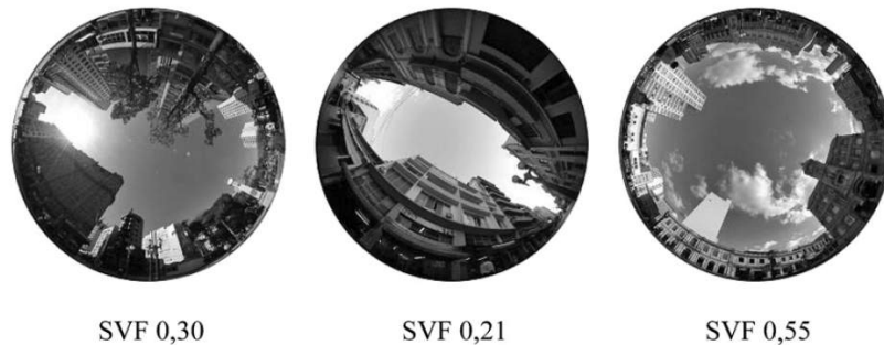
FIGURE 1.5 – Exemples de facteurs de vue du ciel (Sky View Factor donc SVF en anglais) pris avec un objectif fish-eye à Curitiba au Brésil. Source : KRÜGER et al. (2011)
