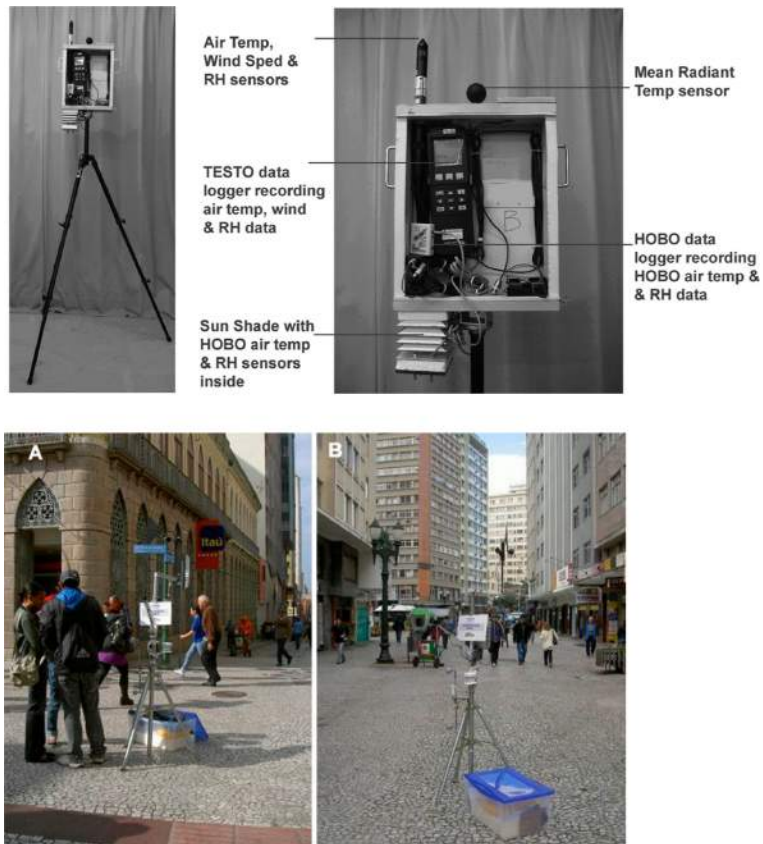
FIGURE 1.9 – Exemples de stations de mesures pour des études de confort thermique. Celle du haut a été utilisée par CHEN et al. (2012) à Hong Kong et celle du bas par BRÖDE et al. (2012) au Brésil.
