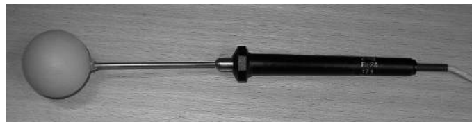
FIGURE 1.10 – Capteur dit 'globe gris' développé et calibré par THORSSON et al. (2007).
