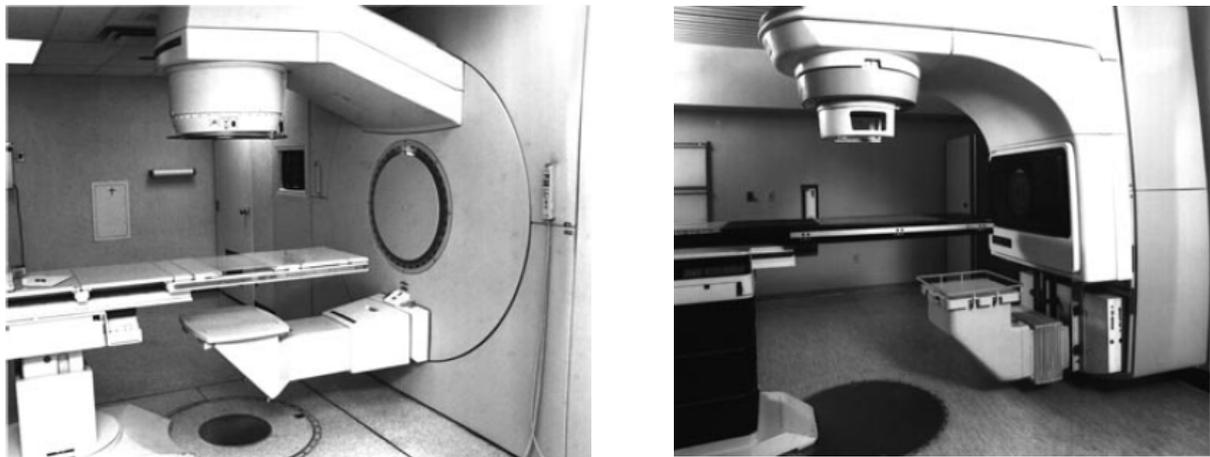
**FIGURE 1.4 : Systèmes d'écran fluorescent – caméra CCD commercialisés. A gauche système iView d'Elekta. A droite système Theraview d'Infimed (d'après Antonuk 2002).**
