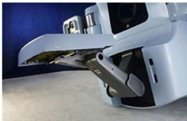
FIGURE 1.8 : Dispositifs d'imageur haute énergie au silicium amorphe embarqués : à gauche, *iViewGt* (Elekta Oncology System), à droite *aS500/1000* (Varian Medical System)
