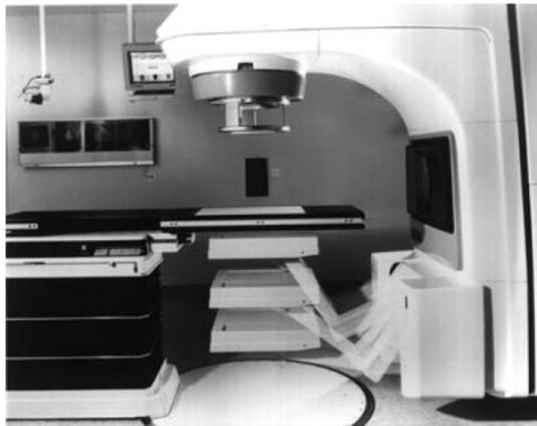
**FIGURE 1.6 :** Système de matrice de chambres d'ionisation liquides PortalVision™ (Varian Medical System) directement embarqué sur l'accélérateur. Visualisation pour plusieurs distances Source-Détecteur (d'après Munro 1995).
