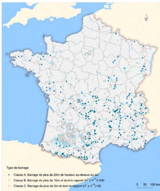
Figure 23. Carte des barrages de classe A, B et C en France métropolitaine. (Modifié d'après MEDDTL, DGPR et ©IGN, GEOFLA®).
