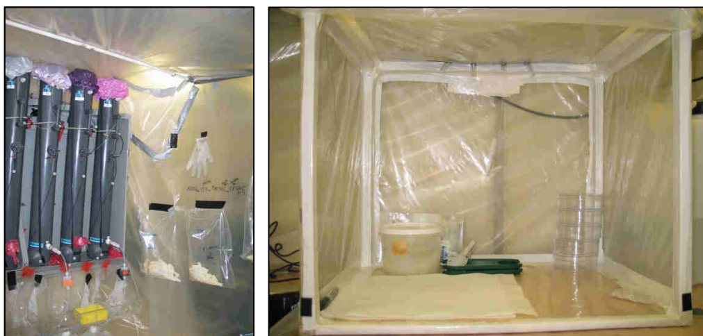
Figure II-3. Le laboratoire « bulle » durant la campagne EUCFe. A gauche, zone de prélèvement. A droite, aménagement d'une hotte à air filtré au sein de la bulle.
