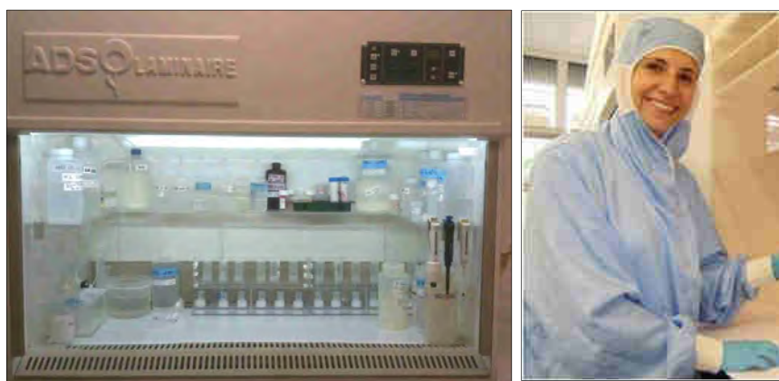
Figure I-I. Conditions de propreté en salle blanche. A gauche photo de la hotte à flux laminaire classe 10 du LEGOS. A droite, photo de l'équipement porté systématiquement en salle blanche.
