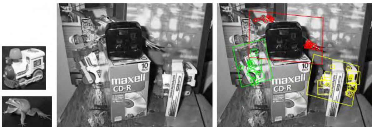
Figure 2-4 Détection d'objets reposant sur SIFT.
