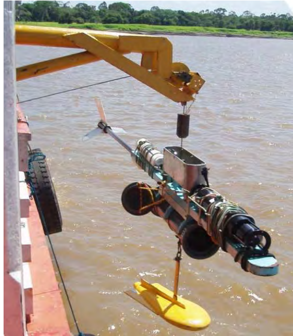
Figura 3.4. Amostrador de fundo Callède I com sonda multiparamétricas e granulômetro laser.
