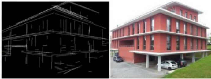
FIGURE 5.4.5 – Construction de modèle de lignes d'un bâtiment
