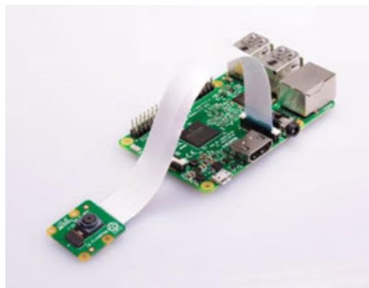
*6.Raspberry Pi con cámara conectada*
