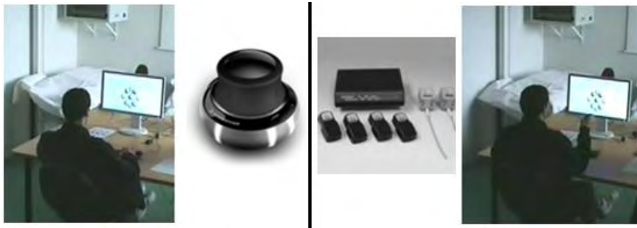
Figure 28. Posture des utilisateurs manipulant les deux techniques d'interaction qui sont le SpaceNavigator, dispositif isométrique (gauche) vs. le Polhemus Patriot, dispositif isotonique (droite).
