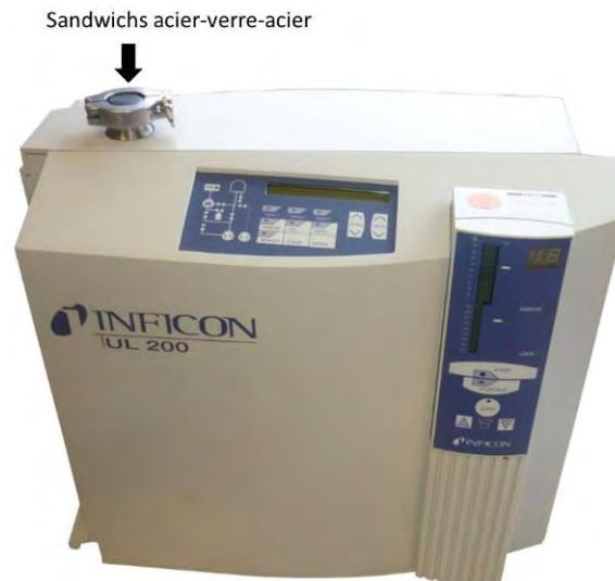
Figure II-8 : Photographie de l'équipement de détection de taux de fuites d'hélium
