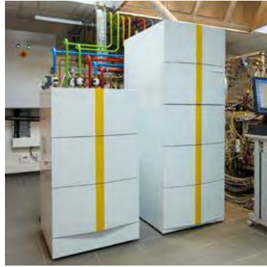
Figure I-2 : Micro-cogénération / Chaudière développée par De Dietrich et Ceramic Fuel Cells et testée par GDF-SUEZ
