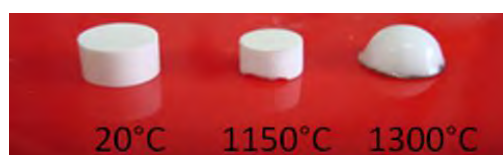
Figure III-10 : Photographies de pastilles de poudre d'oxydes contenant 36% de BaO traitées 10 minutes à différentes températures
