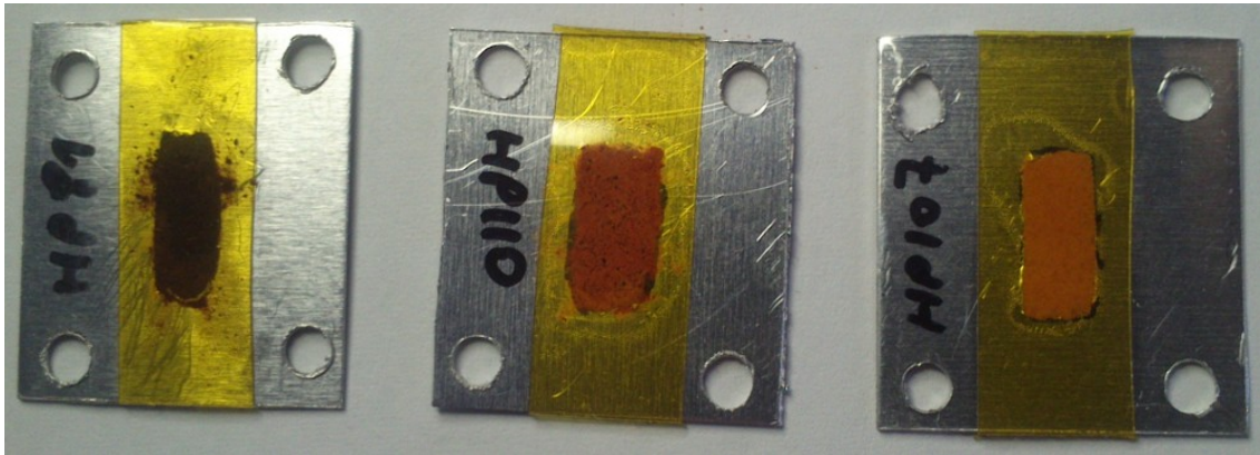
FIGURE III.29 – Portes échantillons pour une mesure de diffusion inélastique nucléaire, remplis avec des poudres contenant des nanoparticules de ^{57}\text{Fe}(\text{pyrazine})[\text{Ni}(\text{CN})_4] .
