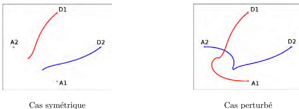
FIGURE 8.1 – Deux avions, guidés de leur point de départ (D1,D2) à leur destination (A1,A2) par la fonction de navigation harmonique.
