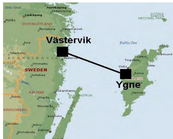
Figure 1: Système de transmission HVDC sous-marin de Gotland montrant les stations de conversion de Västervik et Ygne .
