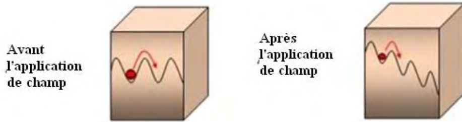
Figure 27: Conduction par saut: schéma de la barrière de potentiel avant et après l'application du champ électrique.
