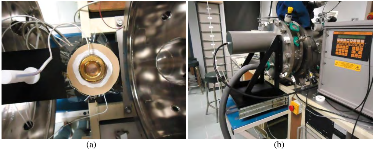
Figure 31: Echantillon monté sur l'électrode (a) et banc de mesure de conductivité (b)
