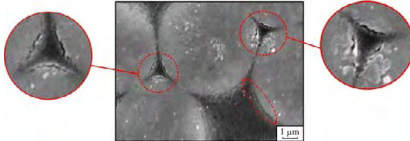
Figure III.11 – Décohésions des interfaces fibre/matrice observées après le processus de polymérisation sur une éprouvette  $[0^\circ]_2$ .
