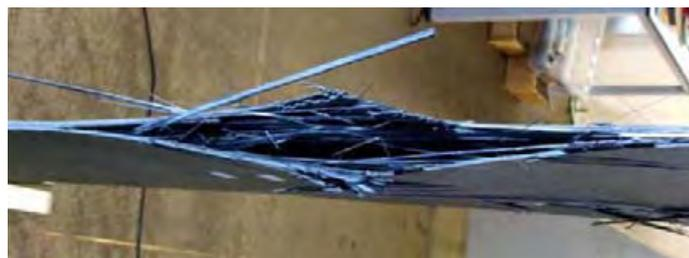
Figure I.2 – Rupture en traction d'un stratifié quasi isotrope troué  $[45_4/90_4/45_4/0_4]_s$  [Wisnom et Hallett, 2009].
