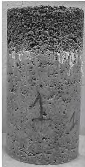
FIGURE 1.8 – Phénomène de ségrégation des granulats caoutchouc en partie supérieure de l'éprouvette [7]
