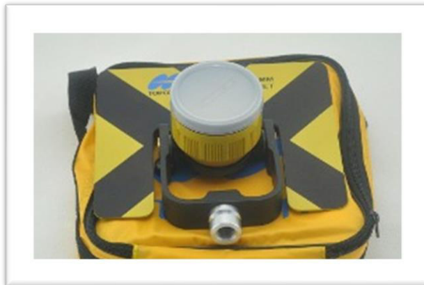
Figura N° 48: Prima y Porta-prisma Topcon
