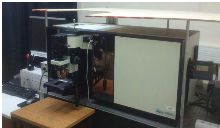
Figure II.39 : Photo du micro-spectromètre Raman.
