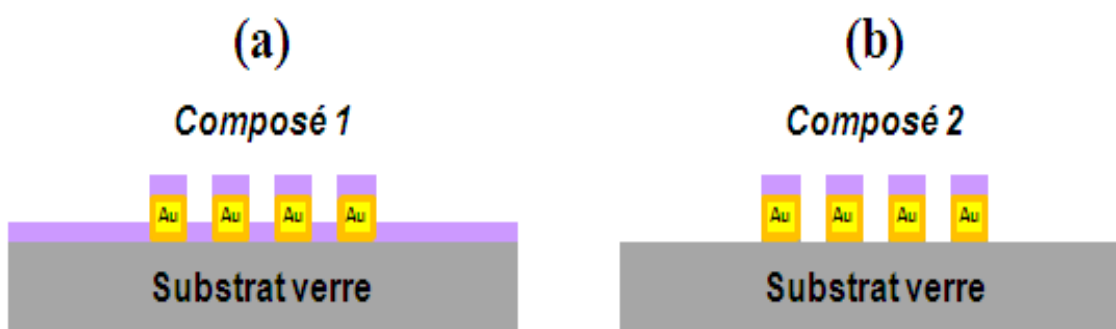
Figure II.30 : Schéma des échantillons LSPR après le dépôt du composé 1 (a) et du composé 2 (b).
