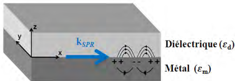
Figure III.1 : Plasmons – polaritons de surface : Oscillation de la densité de charge à l'interface d'un métal ( \epsilon_m ) et d'un diélectrique ( \epsilon_d ).
